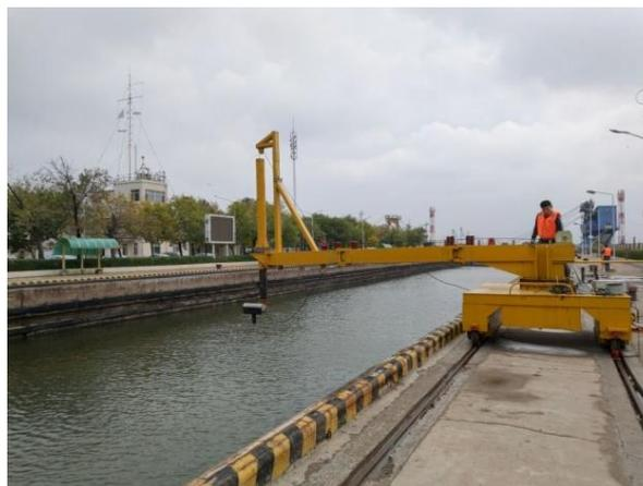
图7 多维运行控制机构
