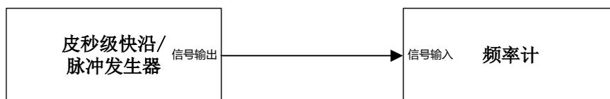
图 3 纯电类皮秒级快沿/脉冲发生器脉冲重复频率校准连接图
